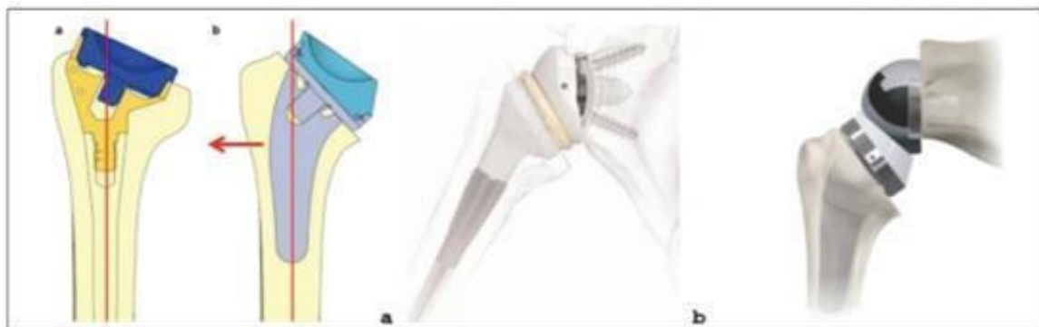
Фиг. 22. Схематично представяне на inlay (a) и onlay (b) системите.
