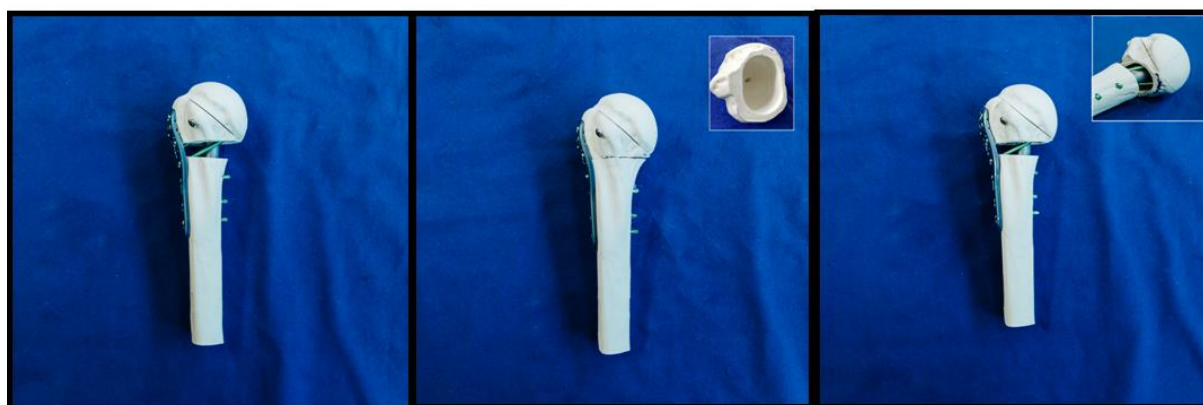
Фиг. 4. Спесимени с добавен ИМГ. Вляво – група 1 (с метафизарен дефект); в средата – група 2 (с остеопоротичен дефект); вдясно – група 3 (с комбинация от дефектите в първите две групи).
