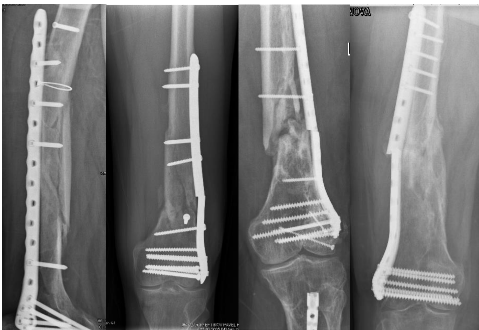
Фигура 26 Представени са случаите на дебриколаж на остеосинтезата. В повечето случаи се наблюдава фрактура от умора на импланта в зоната на пикова стресова концентрация и подлежащо нестрастване на фрактурата.
